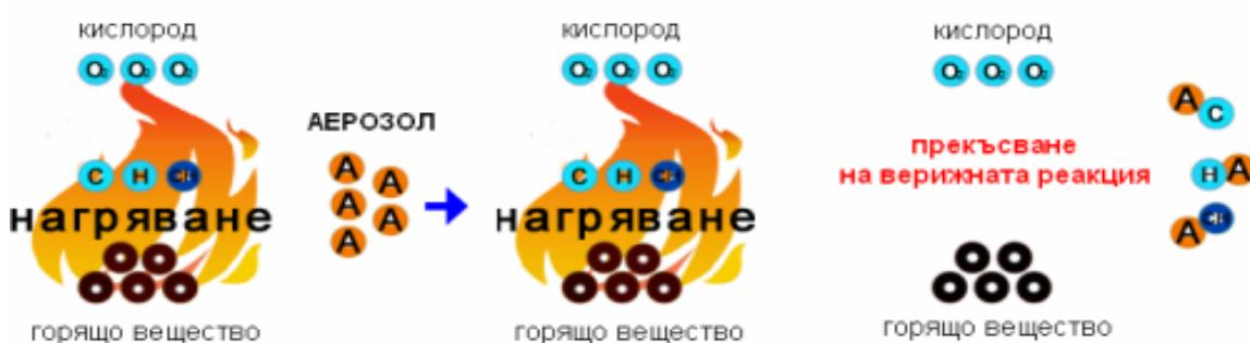
При достигане на пожарогасителна концентрация на аерозола пламенното горене се прекратява, рязко спада отделянето на топлина и постепенно спада температурата в помещението. В продължение на 10-15 минути след приключване работата на генератора, пожарогасителните свойства на генератора се съхраняват, което изключва възможността за повторно запалване.
